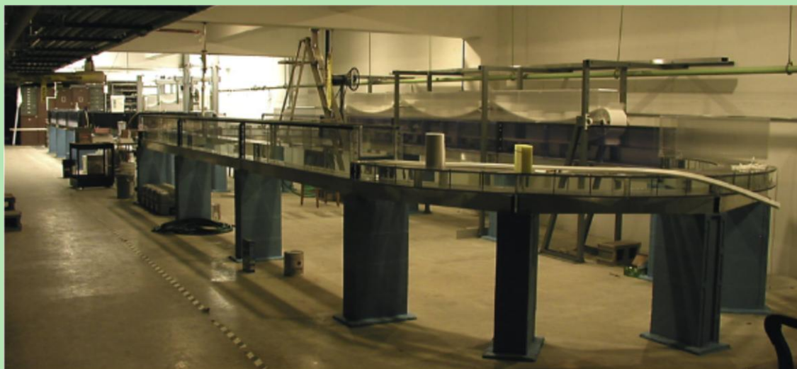
图1 印第安纳大学石英—粉砂和石英—黏土混合实验水槽 [10]
