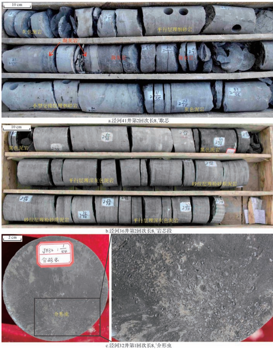
图 12 泾河 41、泾河 36 井和泾河 32 井长 8 1 浅湖—半深湖沉积岩芯照片
