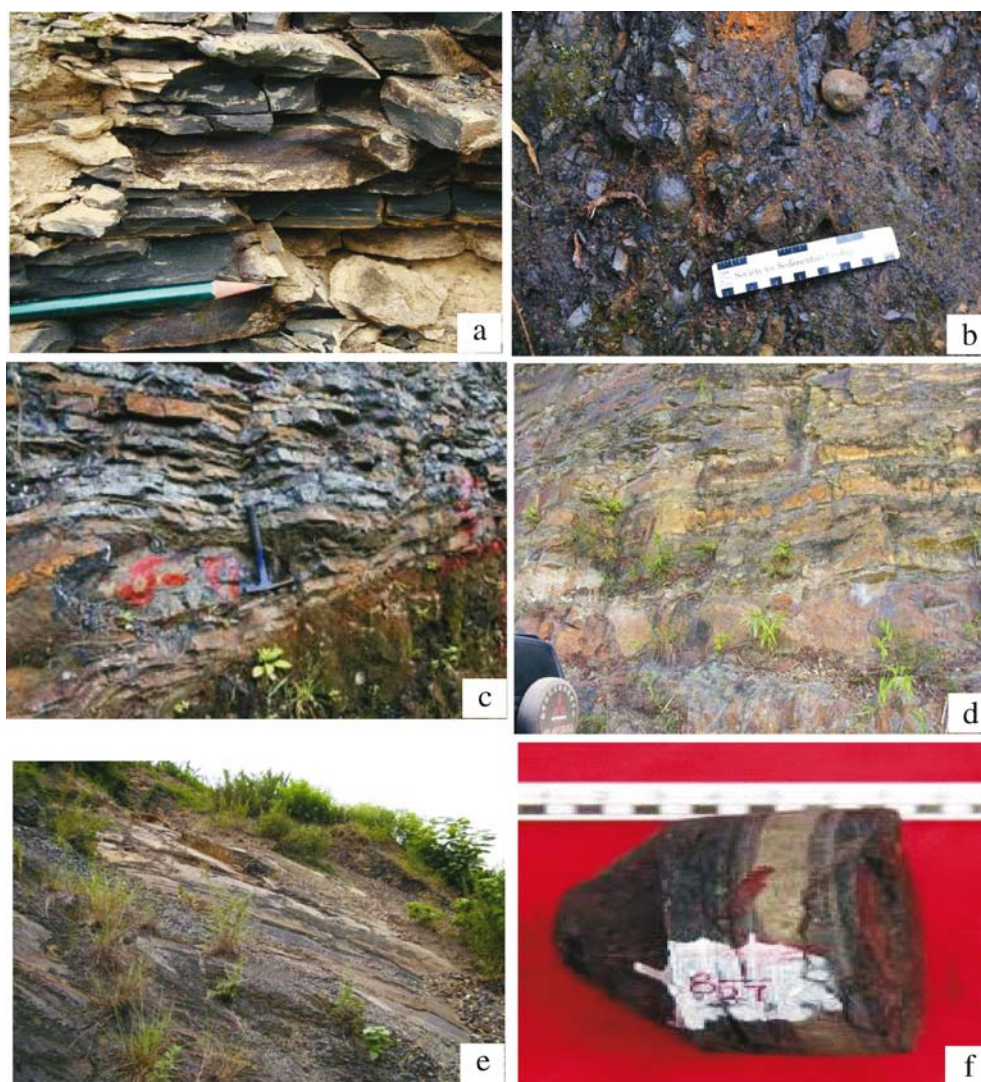
图版说明 I a. 灰色粉砂质页岩, 水平层理, 浅水陆棚相, 下寒武统牛蹄塘组, 金沙岩孔; b. 炭质页岩, 含磷结核, 深水陆棚—斜坡相, 下寒武统牛蹄塘组, 翁安朵丁关; c. 硅质岩夹炭质页岩, 水平层理, 盆地相, 下寒武统牛蹄塘组, 三都渣拉沟; d. 黄绿色中厚层状粉砂—细砂岩夹薄层砂质泥页岩, 深水洋盆, 下寒武统, 宾阳镇龙山; e. 灰绿—灰色灰质砂质页岩, 夹有薄层生屑灰岩或粉砂岩, 水平层理发育, 下志留统龙马溪组, 桐梓县松坎; f. 灰色泥岩、页岩, 夹条带状粉砂岩透镜体, 含有黄铁矿, 水平层理发育, 下志留统龙马溪组, 荆门荆 101 井。
