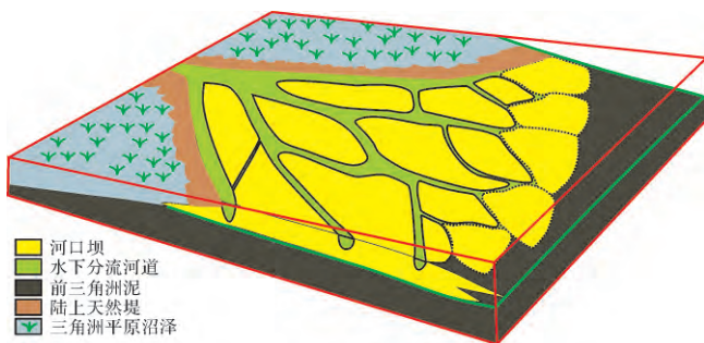
图 10 河控三角洲前缘分流河道与河口坝沉积模式图
