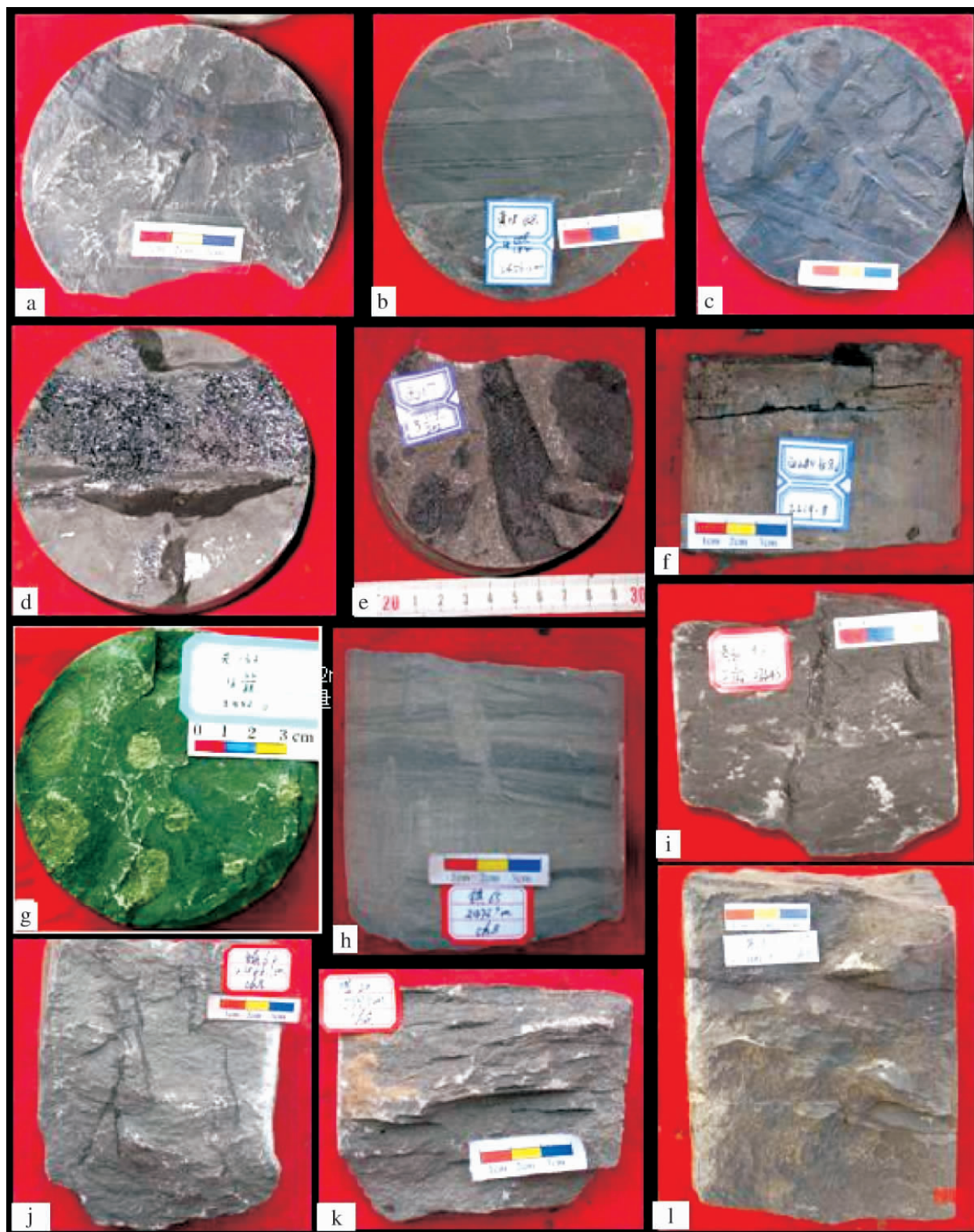
图 4 长 8 油层组反映浅水环境的岩芯照片
