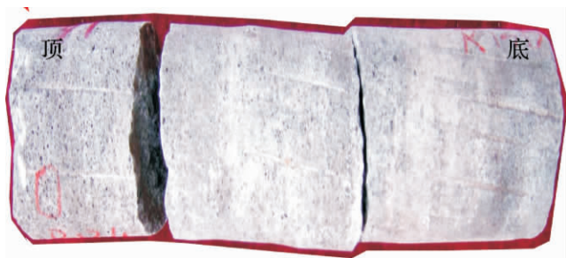
图3 鲕粒灰岩 逆粒序,铸模孔,磨206井, 3186.69~3187.01 m 嘉二 2 A
