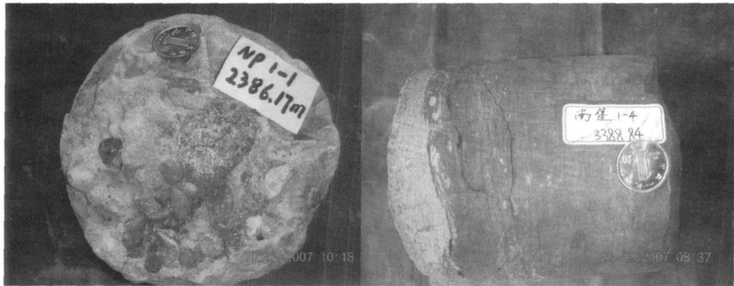
图 3 层序界面识别标志(左:层序底部的砾岩;右:冲刷面)
