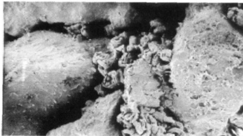
a 高岭石(孔内充填,蠕虫状) \times 500
