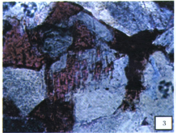
图 3 长石砂岩中的粒间溶孔和粒内溶孔 (红色铸体片, \times 10 , 中富 22 井)
