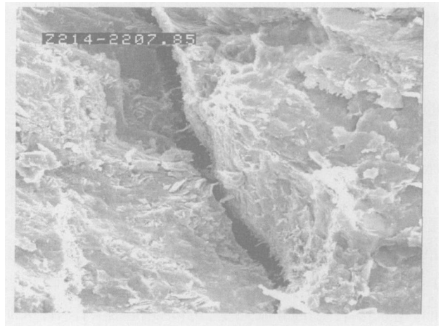
图5 破裂作用形成的裂缝
