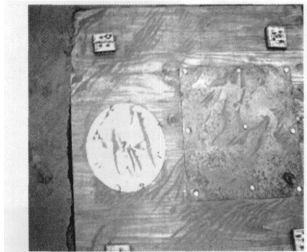
图 2 沉降板、采样纸和沉降板上的沉积物
